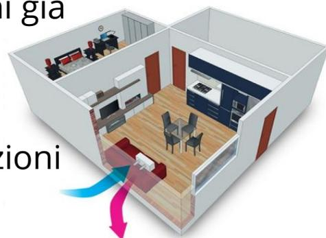
L'impianto di vmc **centralizzato** è il sistema di ricambio dell'aria esteso sull'intera superficie dell'abitazione con un'unica macchina ventilante e una rete di tubazioni e bocchette a parete.
